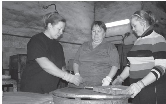
зачерпывается, застывает, получаются своеобразные «пятачки». Эти пробы также отправляются непосредственно в ЦЗЛ с сопроводительными документами, а в ЦЗЛ их зачищают и делают непосредственный химический анализ, результаты «забиваются» в систему «Oracle», и там уже другие контролёры, которые работают на складе чугуна, смотрят результаты химического анализа и определяют марку чугуна.
